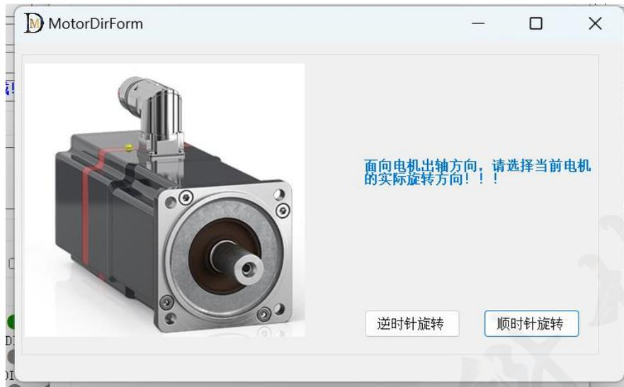
选择正确的旋转方向后, 等待电机自学习第二步完成。然后点击“下一步”, 进入电机自学习第三步。
